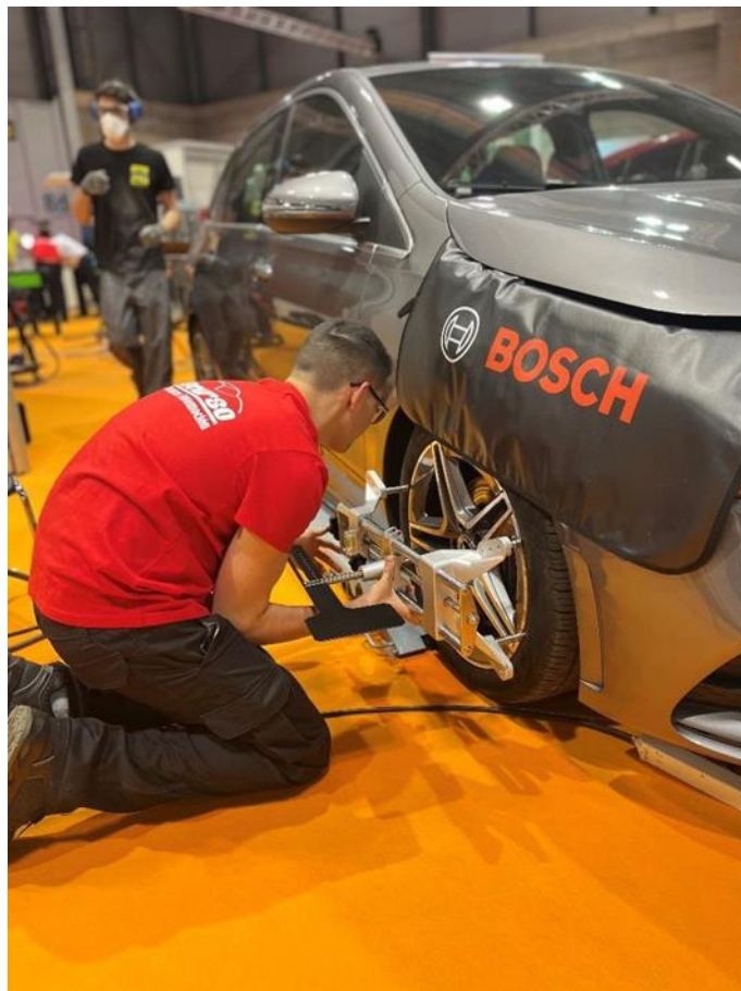
PRUEBA 16: Cambio de discos y pastillas de frenos. Herramientas JBM. Mercedes Benz
